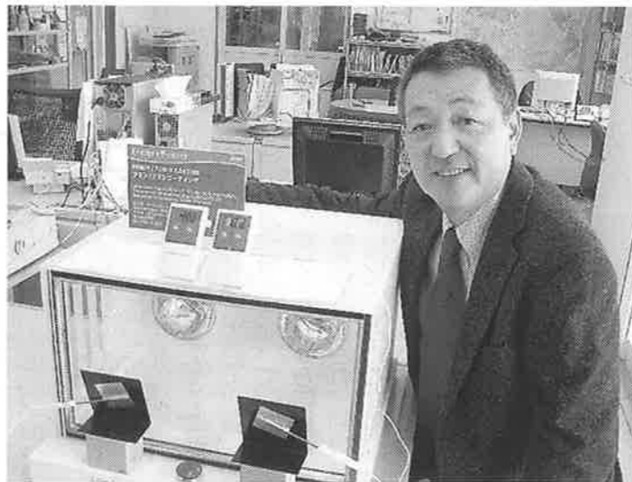
フミンコーティングを塗ったガラスと、普通のガラスを並べてランプを当て、温度上昇の差を示す。海外展示会では行列ができる＝福島市郷野目のフミン本社
